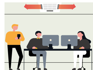
Indirekt luftflöde vid detektering av rörelse.
